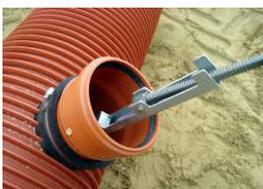
Das Werkzeug durch den Stutzen bis in das Hauptrohr einführen und um 180° drehen, bis der Ausleger kippt.
