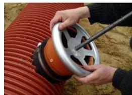
Durch Drehen des Rades das Werkzeug einspannen. Das Rohr gleitet gegen die Stopp-Kante.
